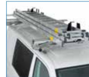
Pour les échelles à 1, 2, ou 3 plans ; longueur maximale : 1,5 fois l'écart entre les traverses du TopSystem ; l'écart entre les traverses peut varier de 1380 à 3000 mm
