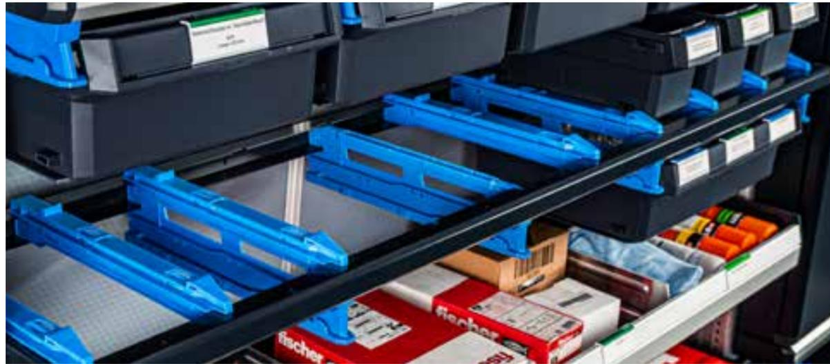
Grâce à ses avantages en termes de prix et de poids, le support pour BOXX constitue une **alternative ingénieuse aux tablettes de profondeur 4** pour intégrer des BOXX dans l'aménagement de véhicule. Le dessus et le dessous du cadre peuvent être équipés de rails dans des configurations différentes, offrant donc une totale liberté dans l'agencement des BOXX. Les fixations ProClick intégrées permettent également de ranger les Sacs à outils ProClick à une hauteur confortable.
