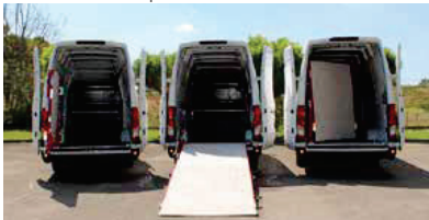
Chemin de marche en aluminium larmé antidérapant
