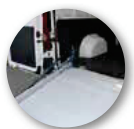
Bande mobile de raccordement à la plateforme de chargement
