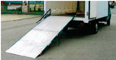
Chemin de marche en aluminium larmé antidérapant
