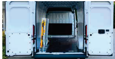
Rebords de sécurité latéraux antichute
