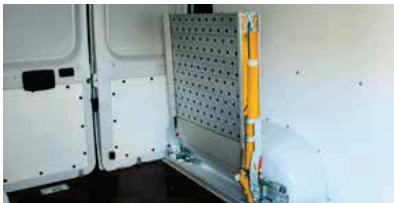
Chemin de marche en aluminium anodisé et perforé
