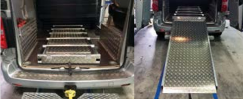
RAMPES D'ACCÈS SOUS PLANCHER
