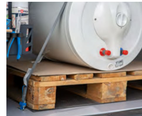
Solutions d'ancrage pour un arrimage professionnel du chargement
